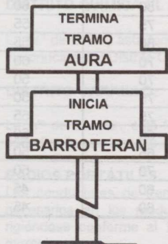
SEÑAL FIJA FONDO BLANCO Y LETRAS COLOR NEGRO, INDICANDO EL INICIO O TERMINO DE UN TRAMO CDT.
